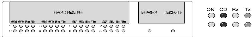
*Figure 2-7. MAX 200Plus error LEDs*
