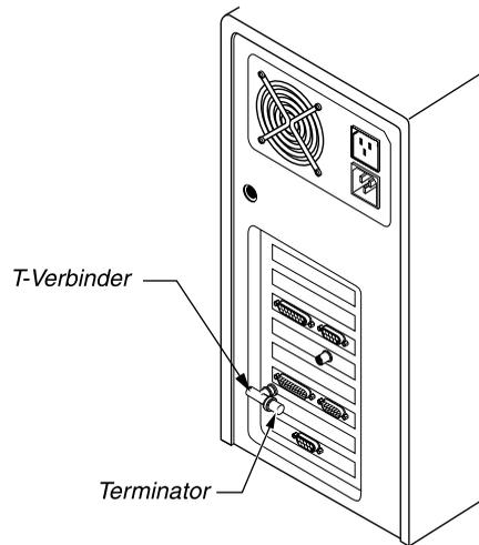
Abbildung 2-10: Anschließen eines zweiten T-Stücks und Terminators
