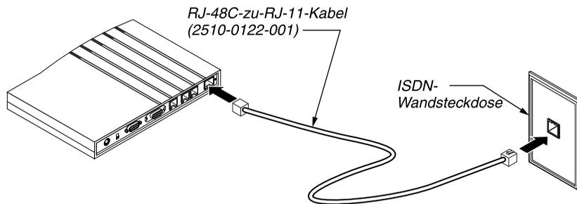
*Abbildung 2-3: Verbinden einer Pipeline mit U-Schnittstelle mit dem ISDN-Anschluß*
