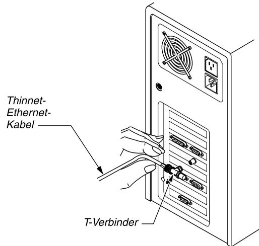
*Abbildung 2-11: Anschließen des Thinnet-Kabels an das T-Verbindungsstück*
