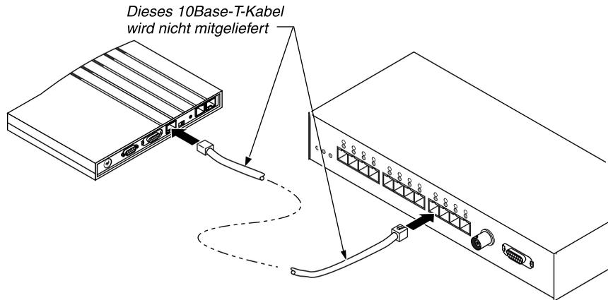
*Abbildung 2-6: Verbinden des 10Base-T-Kabels mit dem Hub*
