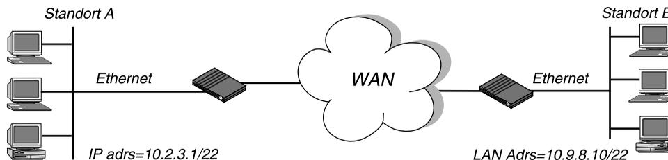
Abbildung 7-9: IP-Verbindung von Router zu Router
