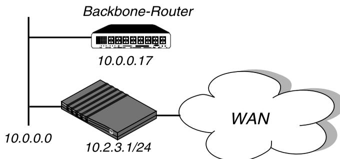
Abbildung 7-4: Aufbau eines Subnetzes für die Pipeline
