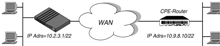
Abbildung 7-6: IP-Routing-Verbindung, die als statische Route fungiert
