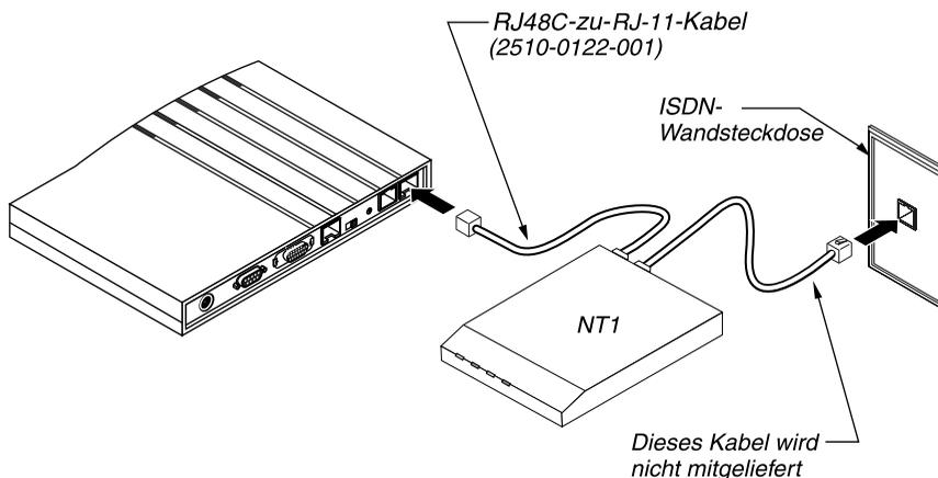
Abbildung 2-4: Anschließen einer Pipeline mit S-Schnittstelle an den ISDN-Anschluß
