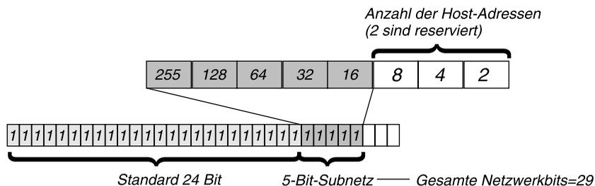
Abbildung 7-3: 29-Bit-Netzmaske und Anzahl der unterstützten Hosts
