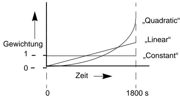
Abbildung 5-1: Bandbreitenalgorithmen für MP+-Rufe
