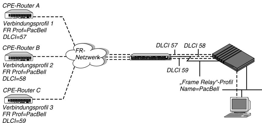
Abbildung 5-2: Gateway-Verbindungen zum Frame-Relay-Netzwerk
