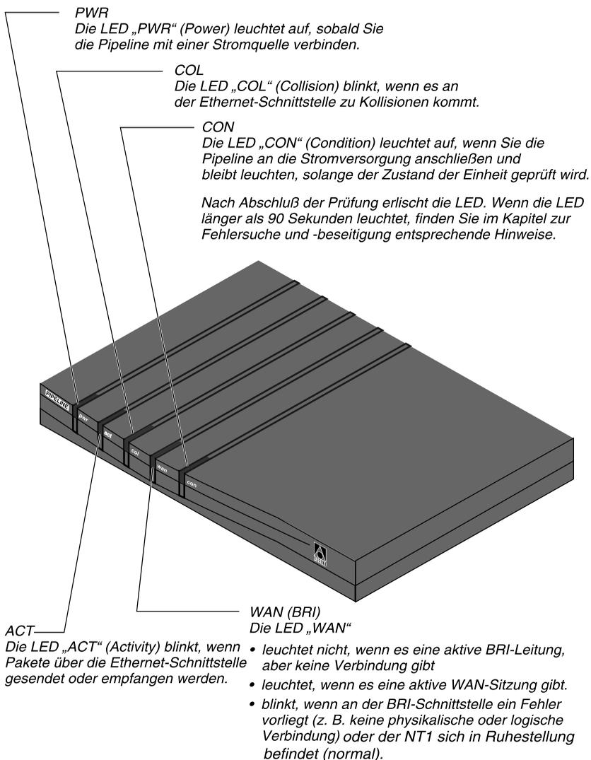
Abbildung 2-17: LEDs an der Frontblende der Pipeline
