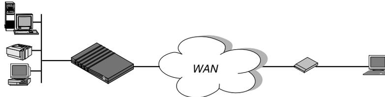
Abbildung 8-1: Einwähl-NetWare-Client, für den dynamisch eine IPX-Netzwerknummer festgelegt werden muß
