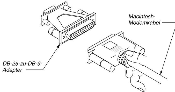
Abbildung 2-13: Anschließen des Adapters an ein Macintosh-Modemkabel
