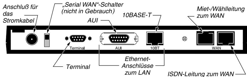
Abbildung 2-2: Rückseite der Pipeline
