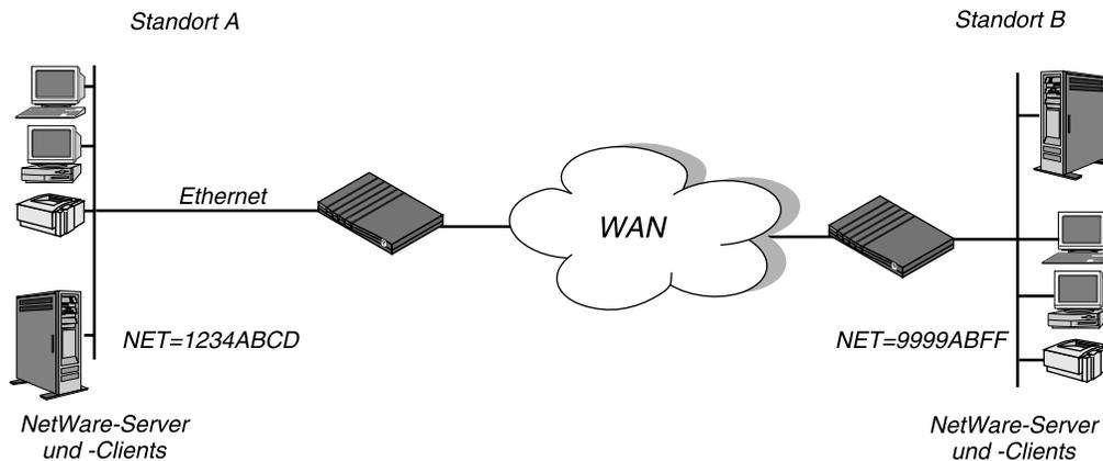
Abbildung 8-2: Verbindung mit NetWare-Servern auf beiden Seiten
