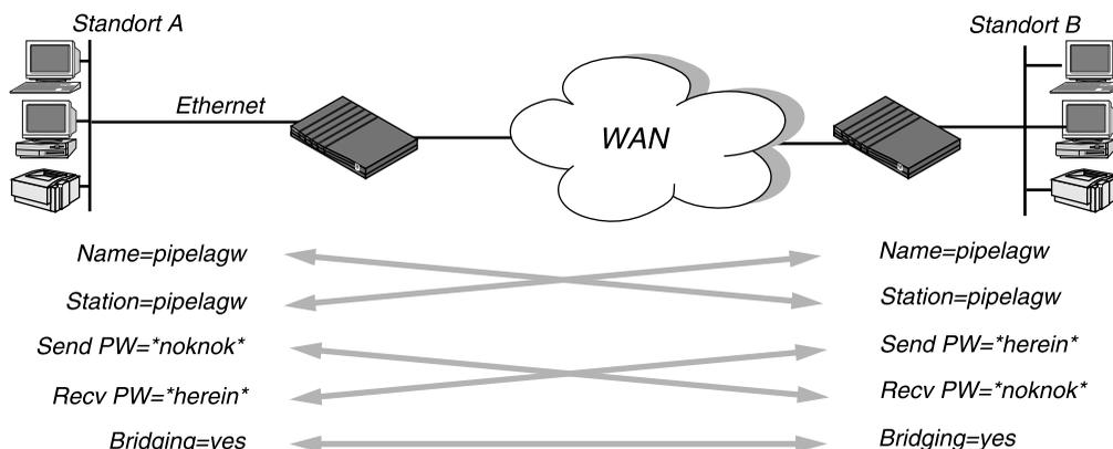
Abbildung 6-1: Aushandeln einer Bridging-Verbindung (PPP-Einkapselung)
