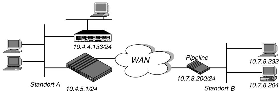
Abbildung 7-10: Verbindung zwischen lokalen und entfernten Subnetzen
