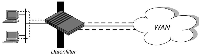
*Abbildung 10-1: Datenfilter können bestimmte Pakete aussondern oder weiterleiten*
