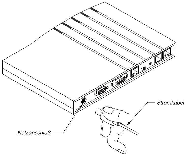
*Abbildung 2-16: Anschließen des Stromkabels an die Pipeline*
