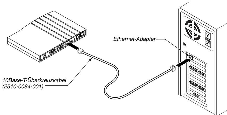
Abbildung 2-5: Anschließen der Pipeline an die Ethernet-Schnittstelle des Computers
