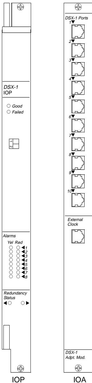
**Figure A-6. 10-Port DSX-1 Module IOP and IOA**
