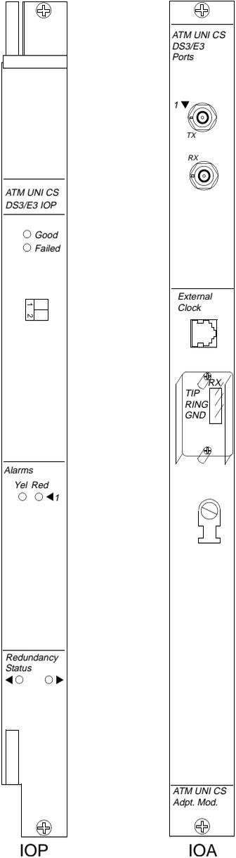
**Figure A-13. ATM UNI CS DS3/E3 IOP and IOA**
