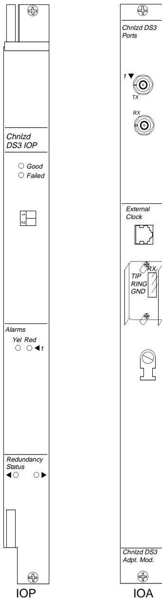
**Figure A-11. Channelized DS3 Module IOP and IOA**
