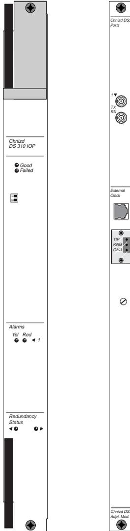
**Figure A-12. Channlized DS3-1-0 Module IOP and IOA**
