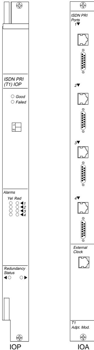
**Figure A-9. T1 ISDN PRI Module IOP and IOA**
