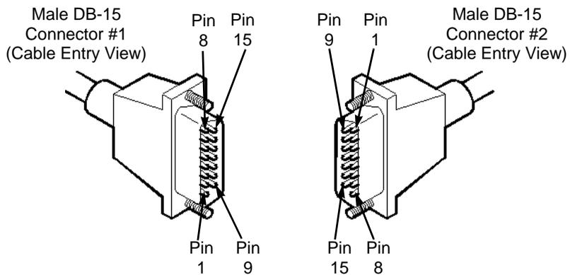
**Figure B-8. X.21 Crossover Cable Diagram**
