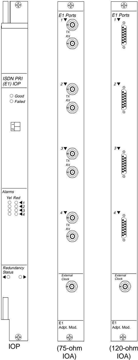
**Figure A-10. E1 ISDN PRI Module IOP and IOA**
