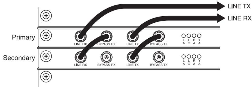
Figure 13-3. ATM DS3 redundant configuration
